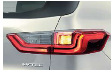
Emergency Stop Signal (ESS) สัญญาณไฟฉุกเฉินอัตโนมัติ ขณะเบรกกะทันหัน
